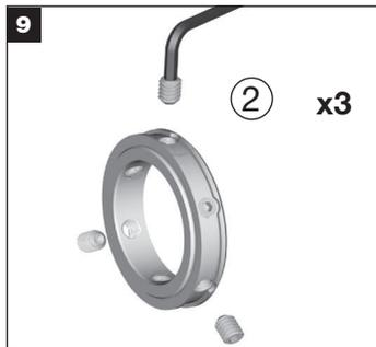
Apriete uniformemente tres tornillos de fijación de punta plana (2) con la llave hexagonal provista. **IMPORTANTE:** Después de haber apretado a mano todos los tornillos de fijación, vuelva a apretar con una llave de apriete:
