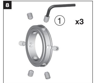
Apriete uniformemente tres tornillos de fijación de macho largo de 1/4 (1) con la llave hexagonal provista.
