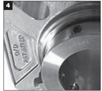
Vuelva a montar la bomba y haga las alineaciones del eje y los ajustes del rotor que sean necesarios. Puede reajustar el rotor en cualquier momento siempre que los clips de centrado estén en su lugar y que los tornillos de fijación del sello estén flojos mientras se mueve el eje.
