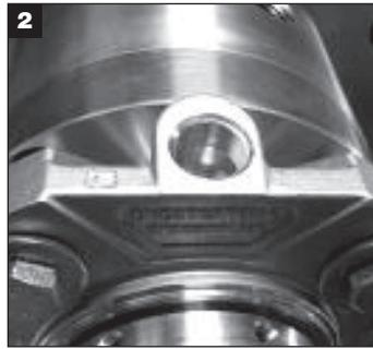
Asegúrese de que el puerto que se está utilizando para la conexión de lavado sea aquel marcado con "F". Listo para instalar el puerto de lavado. **PRECAUCIÓN:** Los puertos de enfriamiento y drenaje se marcan con "Q/D" y estarán tapados con tapones plásticos o tapones para tuberías, y también estarán cubiertos con una calcomanía de precaución.
